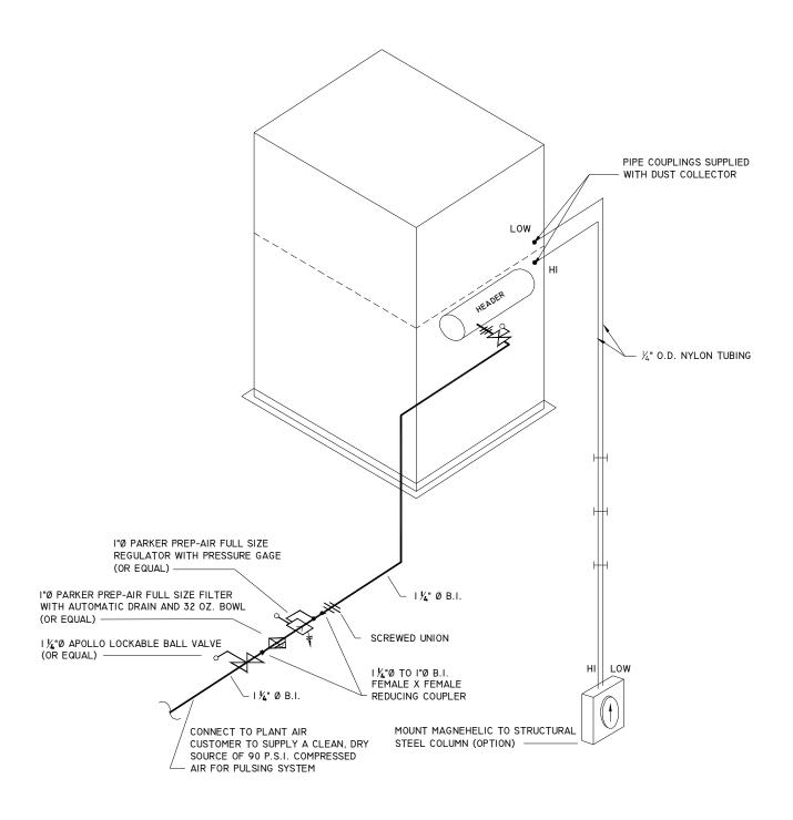
TYPICAL COMPRESSED AIR PIPING SCHEMATIC
